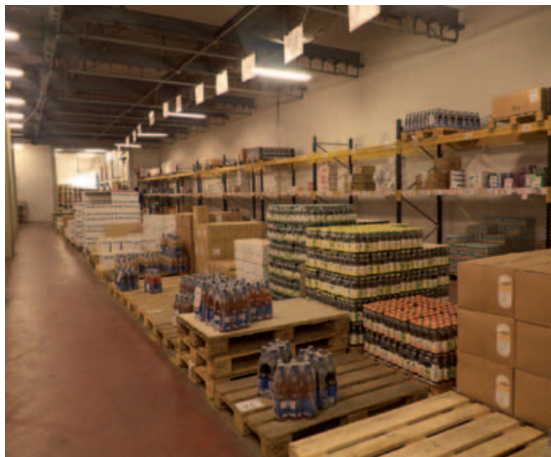
ZONA PICKING A TEMPERATURA AMBIENTE. DALLA ZONA STOCCAGGIO IL PALLET VIENE PORTATO IN QUEST'AREA E VENTILATO IN BASE ALLE LISTE DI PRELIEVO. L'OPERATORE RICEVE L'INDICAZIONE DELL'UBICAZIONE E CONFERMA IL PRELIEVO LEGGENDO IL CODICE BANCALE, CHE VIENE APPLICATO IN SEDE DI INGRESSO E ASSOCIATO AI PRODOTTI.
