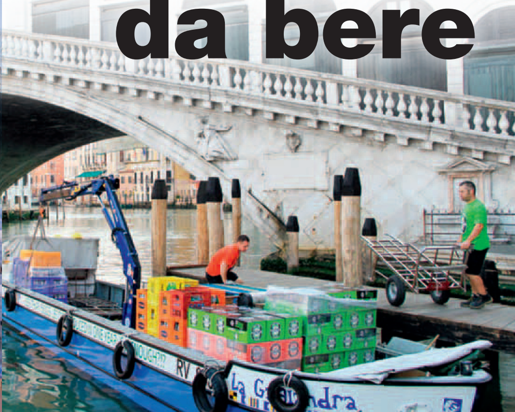
Una delle ultime novità nella flotta di San Marco Beverages. Si tratta della barca a motore elettrico, interamente autostruita, che naviga ormai da circa un anno. La novità non sta solo nel motore, ma anche nella forma stessa, con moto ondoso ridotto grazie alla progettazione ad hoc della carena.
