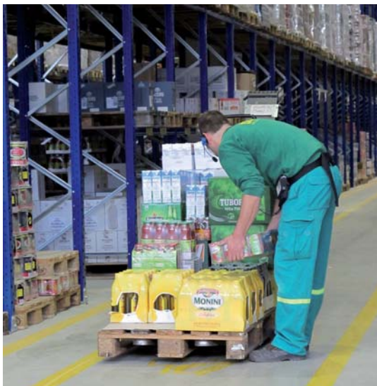
Tutte le operazioni di picking - sia nelle aree a temperatura ambiente sia in quelle refrigerate - sono gestite grazie alla tecnologia vocale, governata dal sistema WMS progettato e personalizzato da Di.Tech, in cui è integrato il modulo vocale vo-CE di Itworks
